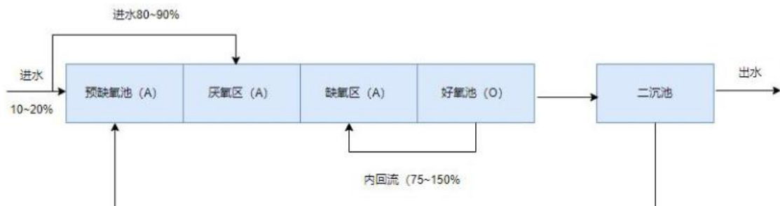
图 4-5 高平市第二生活污水处理厂 A/A/O 工艺流程图
